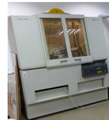
Dyfraktometr rentgenowski z możliwością badania próbek pod obciążeniem
