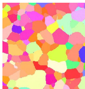
Mikrostruktura przed odkształceniem
